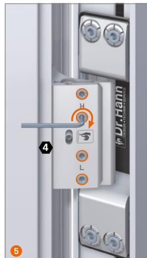
Klemmschrauben festziehen, 1,5 bis 2 Nm.
