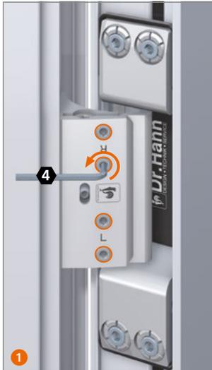
Horizontalverstellung  $\pm 2$  mm (nach Bedarf am oberen und / oder unteren Band) Klemmschrauben leicht lösen.
