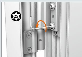
**Befestigungsschrauben des Flügelbandteils entfernen.**
